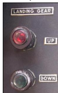
Vous devez respecter la **vitesse maximale de manœuvre du train d'atterrissage** et la **vitesse maximale d'évolution avec le train sorti**. Ces deux vitesses peuvent être identiques (consultez le *Manuel de vol*).
