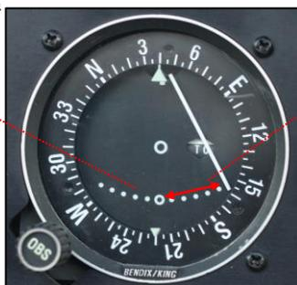
La déviation totale de l'aiguille signifie que vous vous trouvez sur une radiale qui est à  $\geq 10^\circ$  de la radiale sélectionnée.
