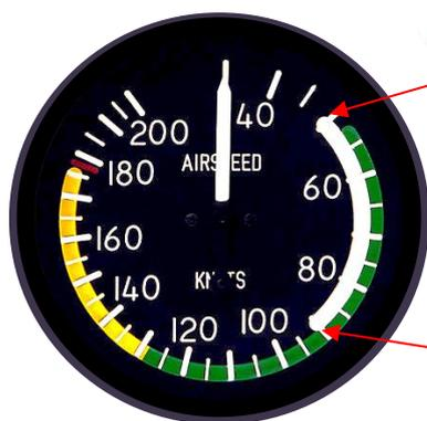
Vitesse de décrochage à la masse maximale en configuration atterrissage ( $V_{S0}$ )
