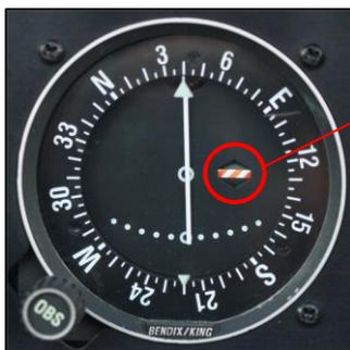
En arrivant à la verticale du VOR dans le cône de silence, le FLAG apparaît pour quelques secondes. Le « TO » disparaît également et il sera remplacé par le « FROM » dès que le signal sera reçu à nouveau.
