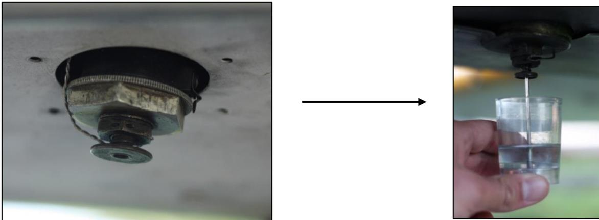
Exemple de cache d'un tube pitot :
