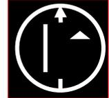
② L'avion est à plus de 10° de l'axe : la barre de l'OBI est en butée à gauche. Pour revenir sur la route vous devez prendre le cap de la route sélectionnée sur l'OBI +/-30° (en fonction de l'écart de route). Dans cet exemple la route sélectionnée sur l'OBI est 040° donc le cap correctif = 40° - 30° = 10°
