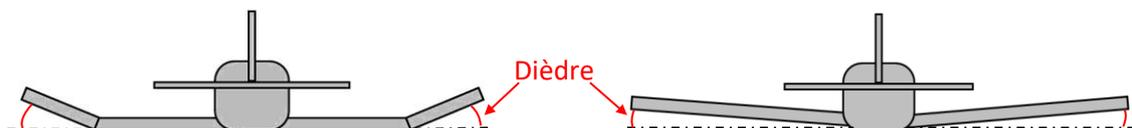
La glissade en latéral crée une composante de flux d'air abordant les ailes latéralement. L'aile la plus basse (l'aile « côté vent »), reçoit le flux sous un angle d'attaque (1) supérieur à l'aile la plus haute (2). Cette différence d'angle d'attaque entraîne une différence de portance ( $P = \frac{1}{2} \rho S V^2 C_z$ ), qui crée le couple redresseur.
